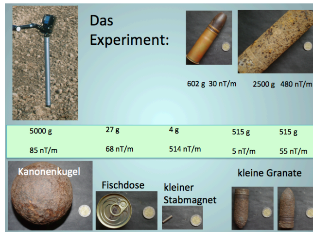
Abb. 7. Experimente zur remanenten Magnetisierung verschiedener Probenkörper mit Angaben zum jeweiligen Gewicht und zu den mit dem Magnetometer ermittelten Messwerten für einen in allen Fällen gleichen Abstand.
